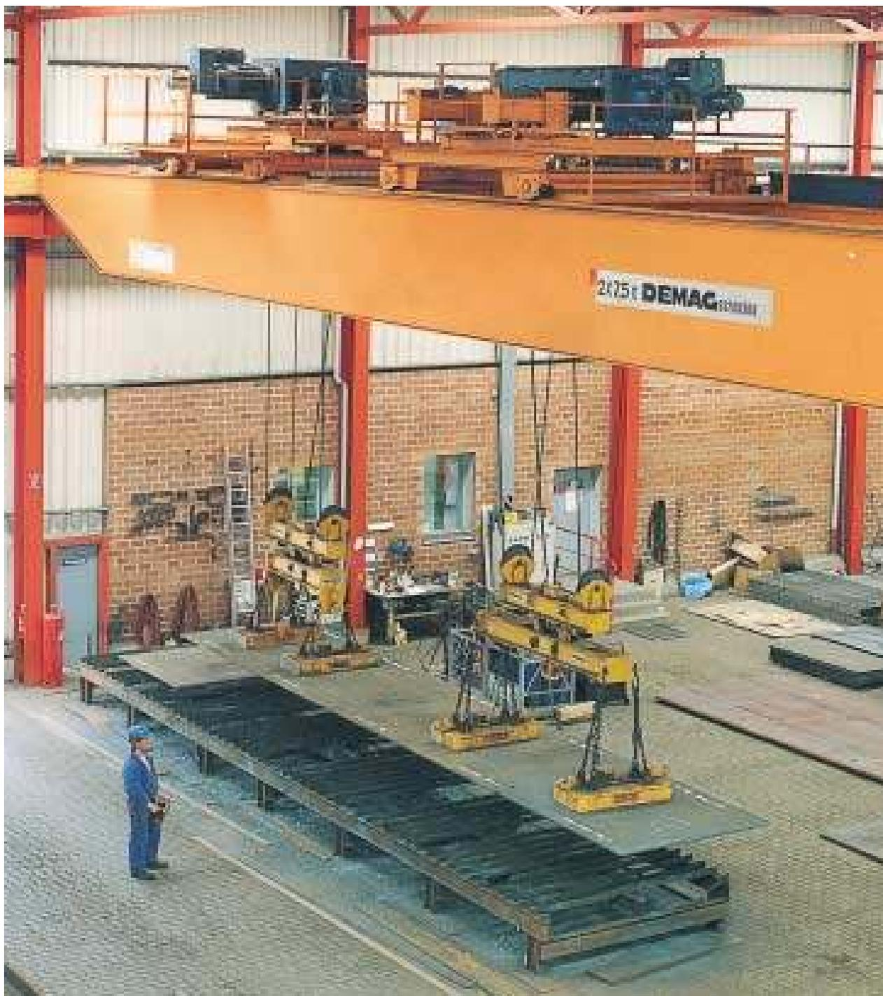
Bei Umsetzarbeiten oder Transportvorgängen, die ein Führen der Last von Hand erfordern, sollte die Last nur gerade bodenfrei, höchstens jedoch in Handhöhe bewegt werden.
