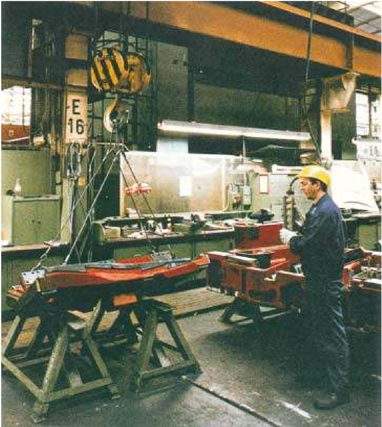
Die **kabellose Steuerung** läßt zu, daß der Kranführer dem Kran in einer angemessenen sicheren Entfernung folgt und steuert. Dies wird besonders wichtig, wenn z. B. flüssige Massen, glühende Schmiedeteile oder Lasten, die durch Kraftschluß (Magnete, Saugheber, Klemmen) gehalten werden, zu transportieren sind.
