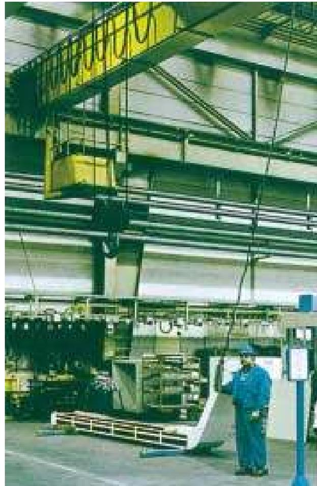
*Bild 3: Krananlage, die wahlweise entweder vom Führerhaus oder von Flur aus gesteuert werden kann*
