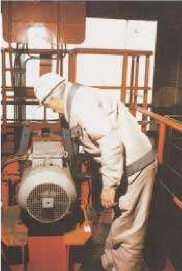
*Bild 16: Der Kranführer prüft den ordnungsgemäßen Zustand einer Kupplung*
