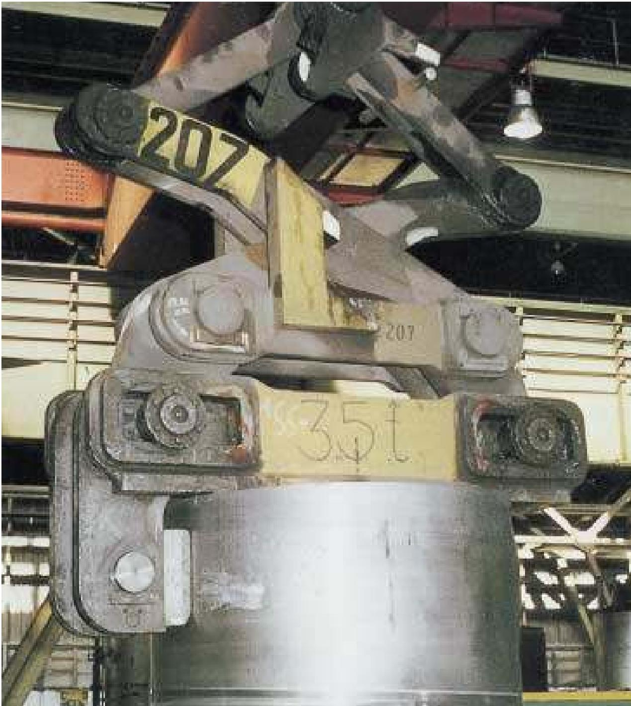
**Kraftschlüssig angeschlagene Lasten dürfen nicht ohne zusätzliche Sicherung über Personen hinweg befördert werden.** Der Einsatz von Stützbatterien ist keine zusätzliche Sicherung. Als zusätzliche Sicherung können zur Anwendung kommen mechanische Einrichtungen, die die Last beim Versagen der kraftschlüssigen Lastaufnahme vor Absturz bewahren, z. B. ein Netz, ein Korb oder eine Unterfangung des Lastweges.
