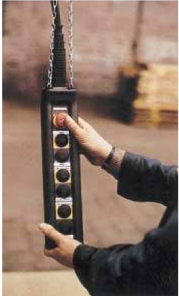
*Bild 50: Bei flurgesteuerten Kranen wird der Kranschalter durch Drücken des auch als „Not-Halt-Schalter“ bezeichneten roten Pilztasters betätigt*
