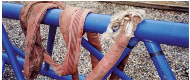
Bild 4-5: Starke Beschädigung der Ummantelung und der Einlage
