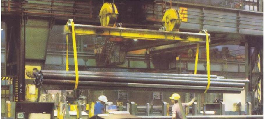
Bild 1-11: Sicheres Anschlagen langer Lasten
