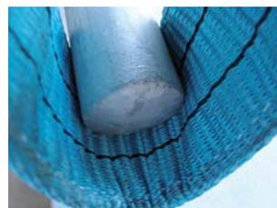
Bild 1-8: Unzulässige Auflage der Last im Hebeband
