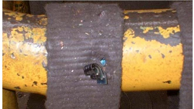
Bild 4-4: Durch heißen Span beschädigte Oberfläche
