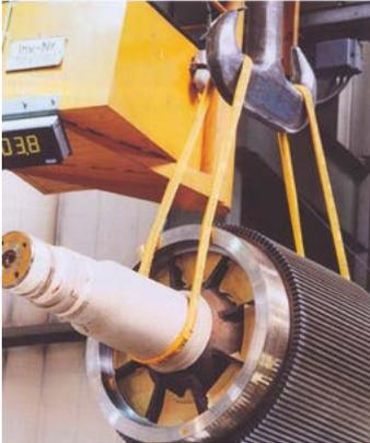
Bild 1-10: Sicherer Hängegang
