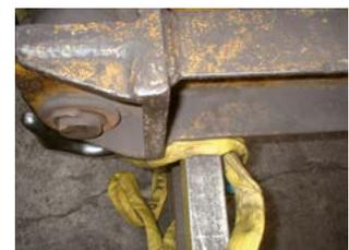
Bild 1-9: Beschädigung einer Rundschlinge durch darauf abgesetzte Traverse
