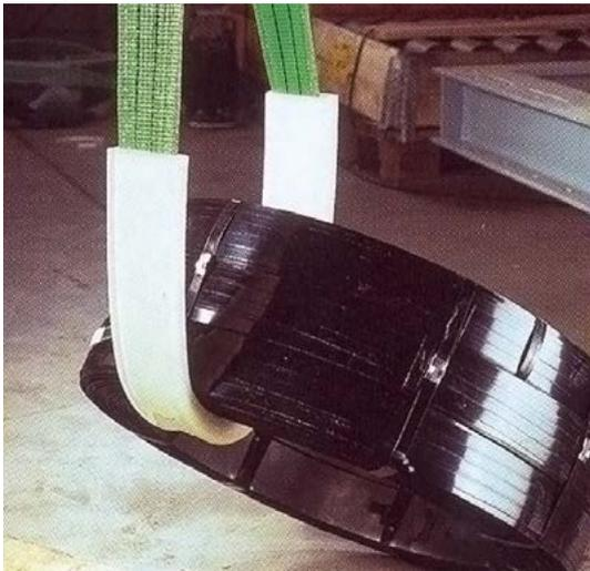
Bild 1-5: Kantenschutz - Schutzschlauch
