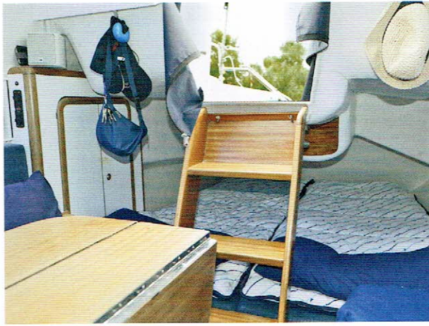
Trotz flacher Bilge bietet die Konstruktion ausreichend Stehhöhe, der Ölzeugschrank findet sich direkt neben dem Niedergang.
