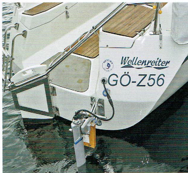
Ein Elektromotor reicht als Flautenschieber völlig aus, Verbrennungsmotoren sind auf dem See nicht zugelassen.
