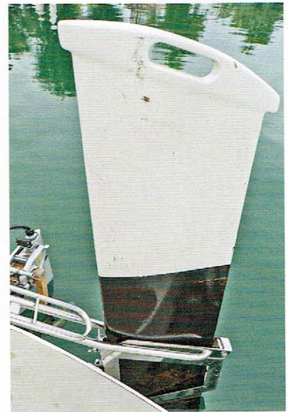
Das Ruderblatt lässt sich einfach aufholen, verfügt aber nicht über eine Vorbalanciering.
