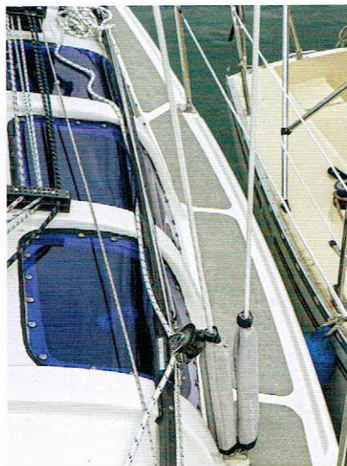
Durch den großen Aufbau bleiben nur schmale Seitendecks, dennoch kommt man gut auf das Vorschiff.
