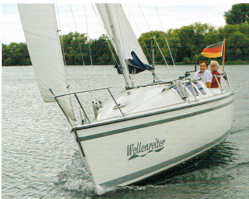
Die J/V-25 kommt schon bei wenig Wind gut in Fahrt, wirkt aber ohne Wasserballast zunächst etwas rank. Das Ausreiten der Crew auf dem Seitendeck kann hier wirkungsvoll für mehr Stabilität sorgen.
